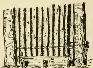
LOG DOOR SILL.
